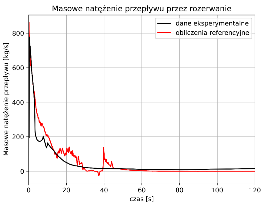
Rys. 6.3. Porównanie masowego natężenia przepływu przez rozerwanie dla danych eksperymentalnych w instalacji LOFT oraz obliczeń referencyjnych dla testu L2-5
